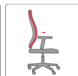
głębokość podparcia łędźwiowego BLS Tiefe der Lendenstütze BLS lumbar support depth BLS
